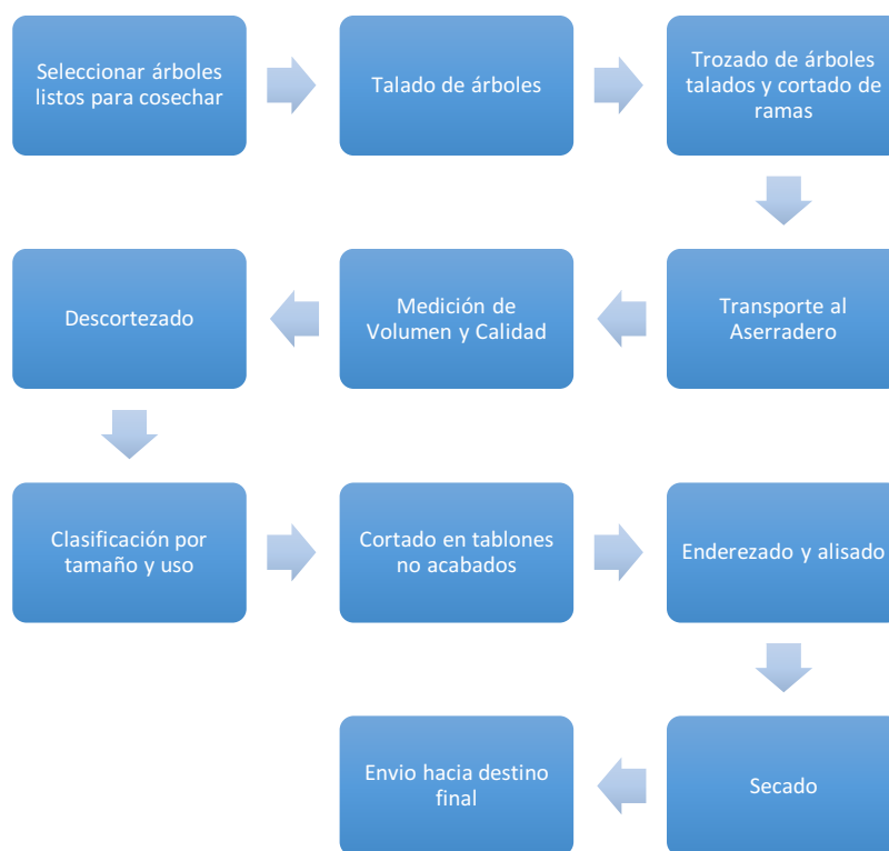
Imagen 17: Proceso de producción de los aserraderos. Fuente: Elaboración Propia.
